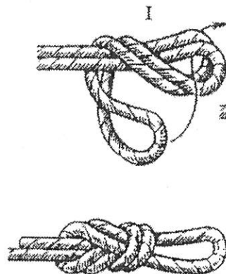
Узел «Восьмерка» без контрольного узла
